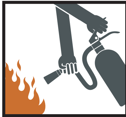
A im at base of fire
